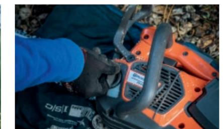
Leicht zu öffnender, aufklappbarer Öltankverschluss für einfaches Nachtanken direkt am Einsatzort.
