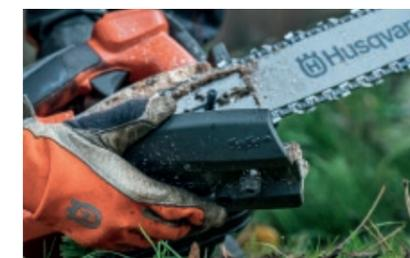
Die Schienenbefestigungsmuttern sind im Kupplungsdeckel integriert und somit vor dem Verlust geschützt.
