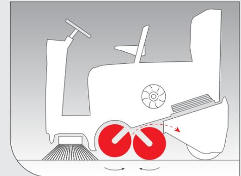
Die gegenläufigen Kehrwalzen des **Doppelwalzen-**
