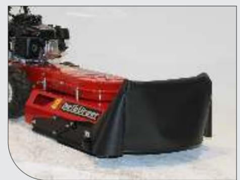
Die **DLG-zertifizierte Schutzplane** verringert den Gefahrenkreis vor der Maschine.
