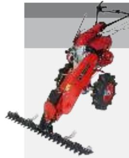
Mähantrieb<br>Rückwärtsanbau, ohne Mähbalken<br>Radgröße 4.00 – 8 oder 16 x 6.50 – 8<br>Rad Ø 430 mm, Gewicht 33 kg<br>Radgröße 4.00 – 10<br>Rad Ø 480 mm, Gewicht 42 kg<br>Radgröße 4.50 – 10 oder 4.00 – 12<br>Rad Ø 500 mm, Gewicht 40 kg | <b>AB-054-030TS</b> |         |                     |                     |
