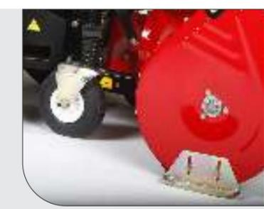
Stützräder und Gleitkufen zur Entlastung der Vorderachse
