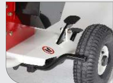
Die Feststellbremse sorgt für einen sicheren Stand während der Arbeit.
