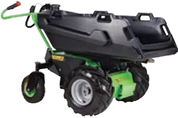
Mit dem Tankbehälter ausgestattet können bis zu 280 kg oder 180 Liter auf einmal befördert werden (400 Liter mit Seitenwänden MBER), wobei die Leerung mit Zentralhebel unterstützt ist. Der in die Wanne integrierte Tank ermöglicht den Transport von 85 Litern Flüssigkeit, welche Sie über einen Ablasshahn, oder eine Sprühdüse (nicht enthalten) auslassen können.
