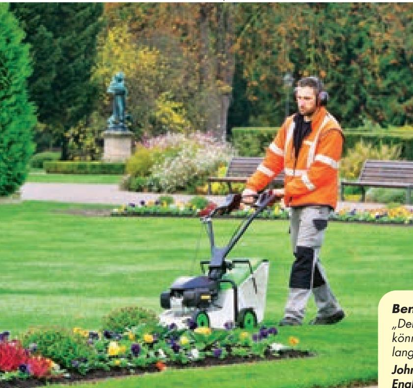
Die PRO 46-Modelle bieten die Möglichkeit, unter allen Bedingungen mit oder ohne Sammeln zu mähen. Eines der Hauptmerkmale der PRO 46 ist das "One Cut"-Prinzip. Dies bedeutet, dass das Gras nur einmal geschnitten wird, bevor es in den Grasfangkorb befördert wird. Die Vorteile: dies reduziert den Verbrauch erheblich und verhindert, daß das Gras am Mähdeck kleben bleibt, wodurch eine wiederholte Verstopfung des Kanals vermieden wird.
