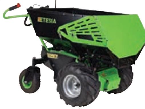
Mit der Blechwanne können Sie in einem Arbeitsgang bis zu 280 Kg oder 250 Liter bewegen. Das Entleeren wird durch einen zentralen Hebel unterstützt. Dank der robusten Wanne können Sie Materialien wie Kies oder Steine transportieren.
