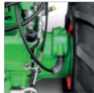
Robuste Lenkbremskupplungen für einfaches Lenken
