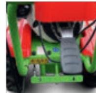
Fahrtrichtungswechsel vorwärts/rückwärts einfach per Fußhebel schaltbar
