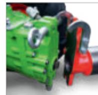
agria-Anbauflansch: einfacher und schneller Anbaugerätewechsel
