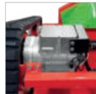
Bürstenlose und somit wartungsfreie Elektromotoren
