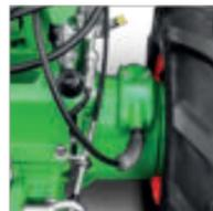
Robuste Lenkbremskupplungen für einfaches Lenken
