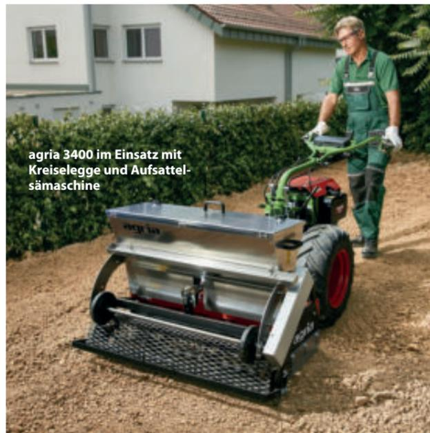
agria 3400 im Einsatz mit Kreiselegge und Aufsattelsämaschine
