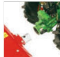
Rohrbaufansch: einfacher und schneller Anbaugerätewechsel
